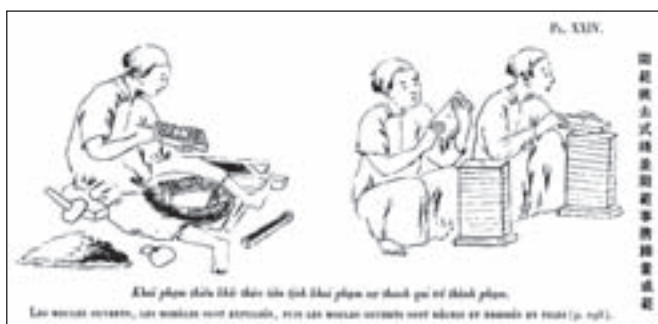
Obr. 12: Hotové licí formy se zkouší a skládají se na sebe. Tabulka 24.
